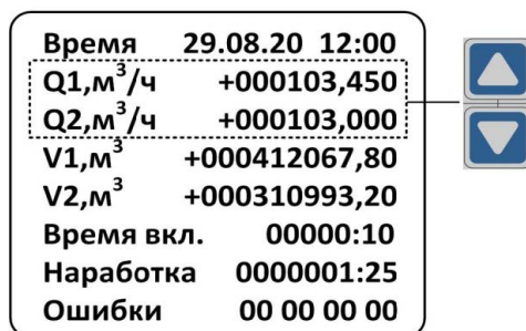
Рисунок 5.1 – Окно списка параметров 2-канального расходомера
